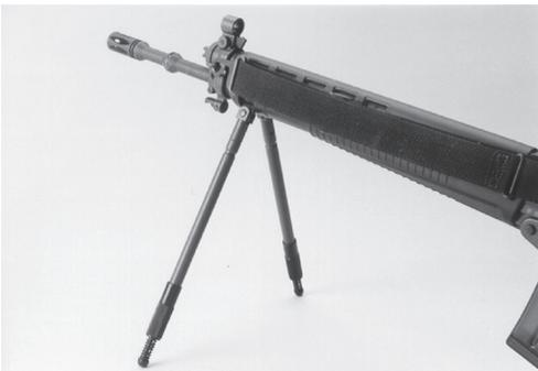
*Bild 2: Verstellbare Zweibeinstütze zu Stgw 90, diverse Fabrikate*
